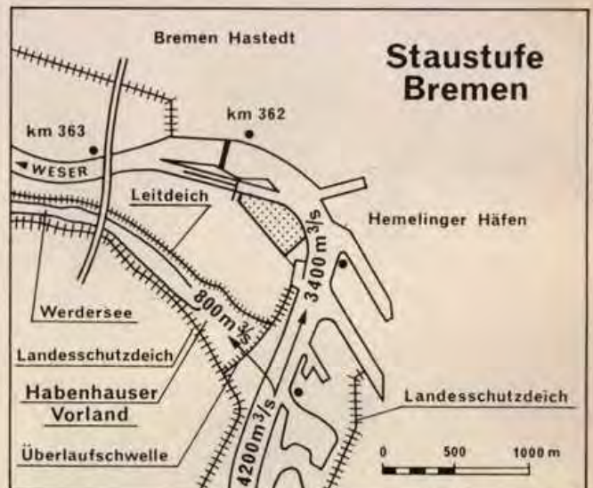
Lageplan Staustufe Bremen – Hochwassermengenverteilung 1906
