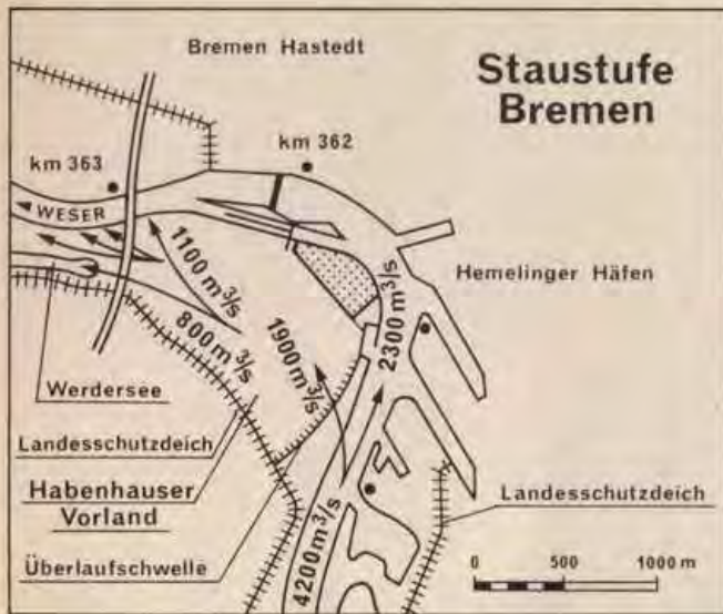
Lageplan Staustufe Bremen Hochwassermengenverteilung 1984 Ausbildung eines Zweirinnensystems
